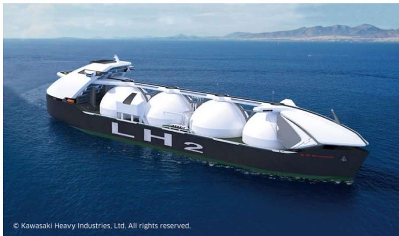
（160,000m<sup>3</sup>型 液化水素運搬船コンセプト図 提供：川崎重工業株式会社）
